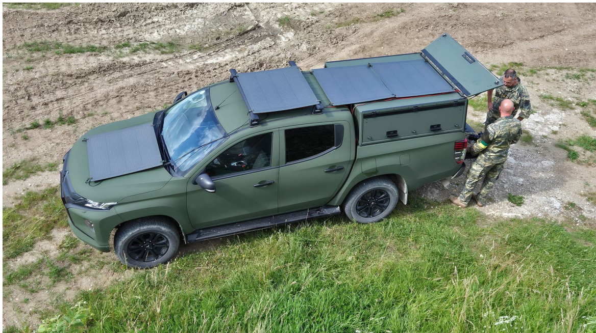
► Installation von vier Modulen Solar Shield auf Mitsubishi L200...
