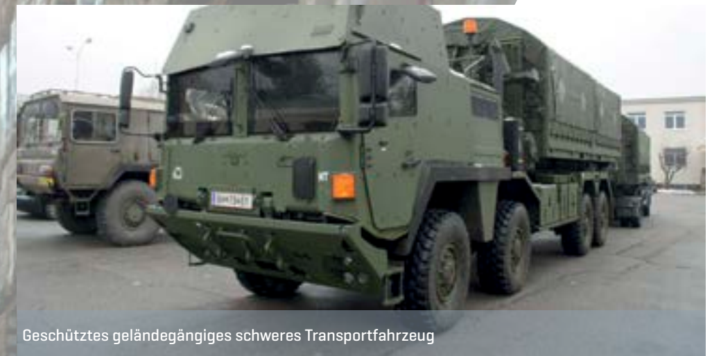
Hakenlasttransporter im Konvoi
