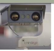
Meduza X erkennt, klassifiziert und verfolgt Drohnen dank einer Kombination aus Wärmebildgerät, eines elektrooptischen Systems und effizienter Algorithmen.
