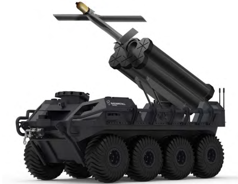
Abbildung 22: Konzeptstudie eines Loitering Drohnen mitführenden UGCV. 99
