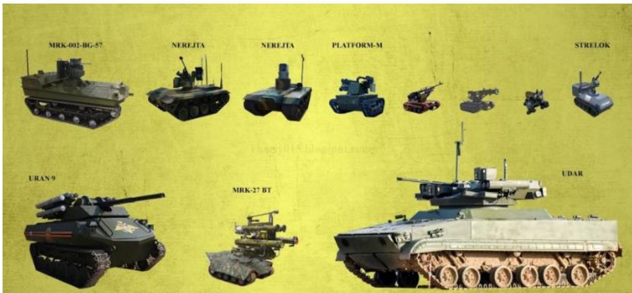
Abbildung 1: Beispiele für bereits entwickelte UGV-Systeme der russischen Streitkräfte: Unterschiedliche russische UGV, darunter bereits bewaffnete UGCV-Systeme.<sup>26</sup>
